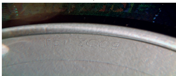
obr. č. 13 – Mould kód na optickém médiu (CD DVD)
